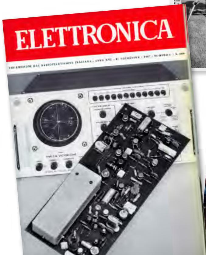
1967 - Decodificatore per televisione a colori sistema PAL, realizzato dal Laboratorio Ricerche della Rai. E' ben visibile la linea di ritardo che è del tipo a ritardo esatto preparato. In secondo piano appare un vettorscopio, strumento fondamentale nella televisione a colori.
