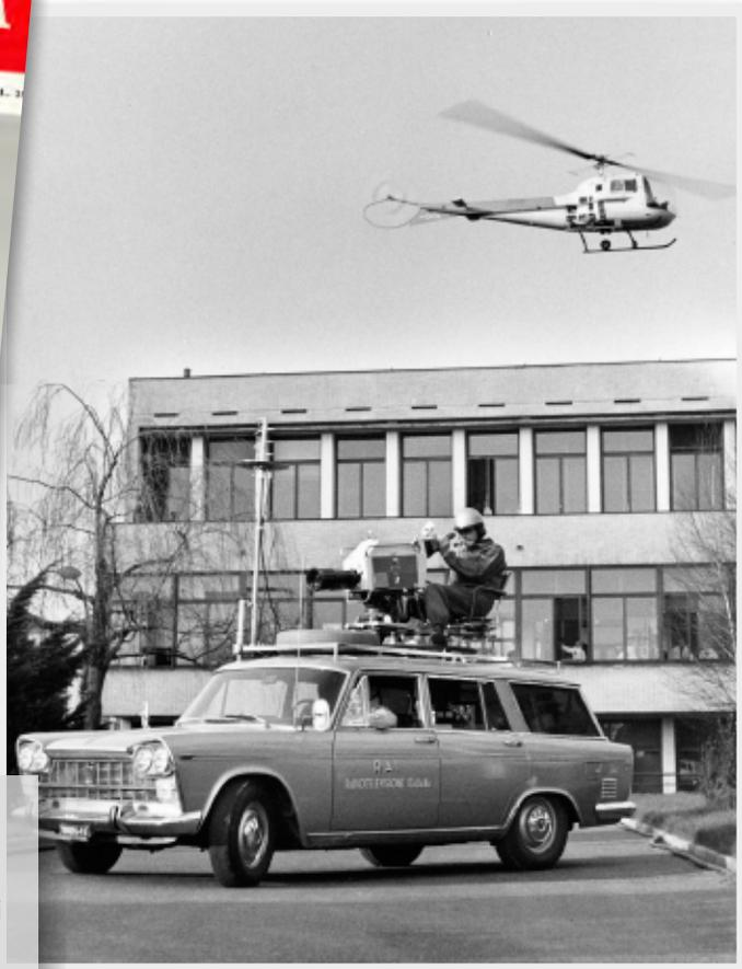
1967 - Telecamera transistorizzata, progettata e costruita nel Laboratorio Ricerche della Rai, montata sul tetto di un'automobile. Le sue caratteristiche di limitato peso ed ingombro e di alimentazione mediante batteria di 24 volt con basso assorbimento (80 watt) consentono un suo largo impiego specialmente per le riprese esterne in movimento.
