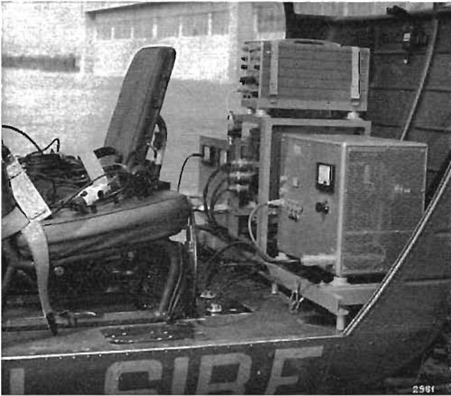
Fig. 25. — L'elicottero è attrezzato con ricevitori e trasmettitori. Il tecnico, seduto in senso opposto al pilota, controlla gli apparati e commuta sul collegamento verso terra i due segnali video ricevuti. Attualmente è in studio il collegamento doppio completo che eliminerà la necessità del tecnico a bordo.
