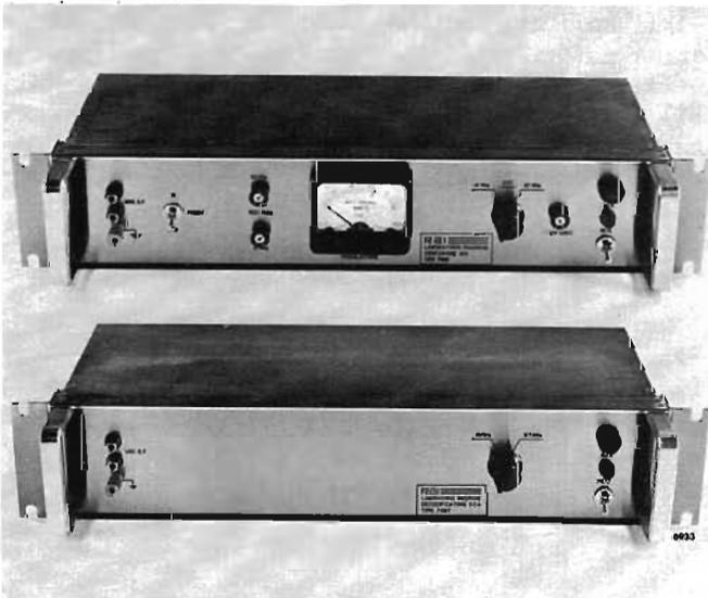
Fig. 40. — Codificatore (sopra) e decodificatore (sotto) per la trasmissione, a mezzo di sottoportanti a 41 e 67 kHz, di due programmi ausiliari con i trasmettitori radiofonici a modulazione di frequenza. Essendo la banda audio limitata a 6 kHz, la qualità è analoga a quella delle trasmissioni ad onde medie.
