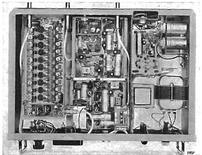
Fig. 21. — Collegamento video in cavo coassiale a frequenza portante a 20 MHz. Impiega la modulazione di ampiezza con entrambe le bande laterali ( $\pm 7$  MHz a livello). La foto mostra il modulatore. Da notare, sulla parte sinistra, l'amplificatore lineare finale di tipo « distribuito » formato da dieci sezioni con due transistori ognuna.
