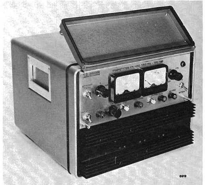
Fig. 26. — Trasmettitore a MF video ed audio per collegamenti TV da 10 W in banda V. L'amplificatore di potenza è seguito da un moltiplicatore per due. La stabilità di frequenza è ottenuta ponendo l'oscillatore in camera termostatica.
