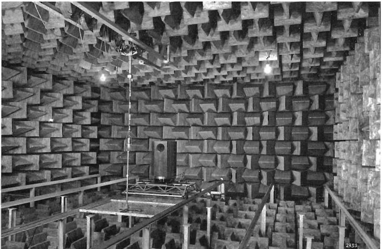
Fig. 5. — Interno della camera anecoica attrezzata per l'esame di un microfono.
