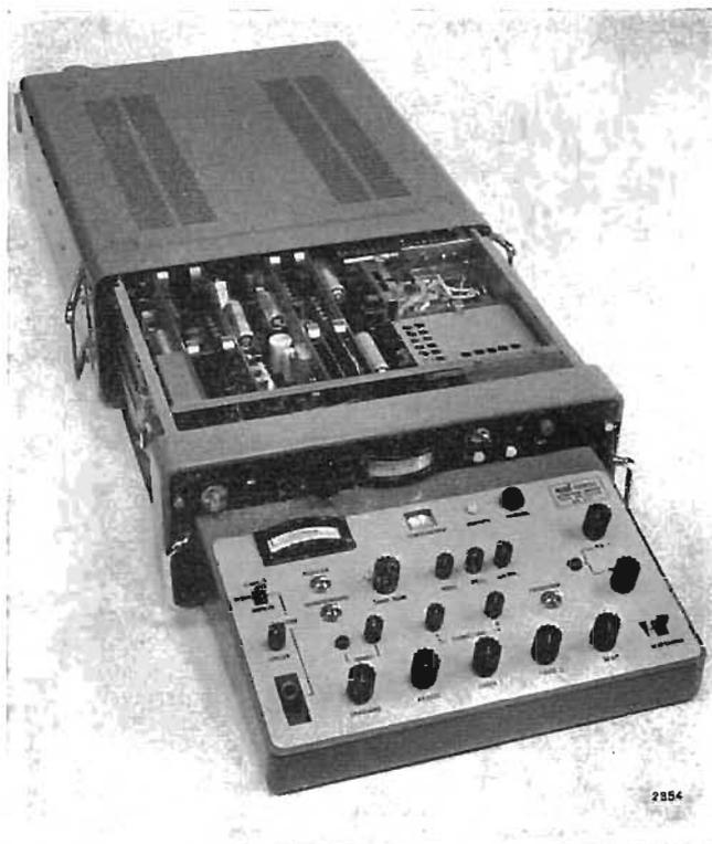
Fig. 18. — Controllo per telecamera che contiene i circuiti di alimentazione e di regolazione della telecamera. Il pannello di comando è estraibile e può essere montato anche a distanza.
