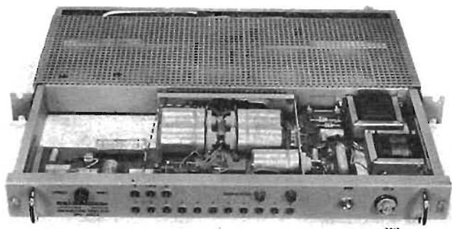
Fig. 14. — Distributore di segnali video. Sono visibili sul davanti i dieci punti di controllo delle uscite. La potenza assorbita è di 12 W.
