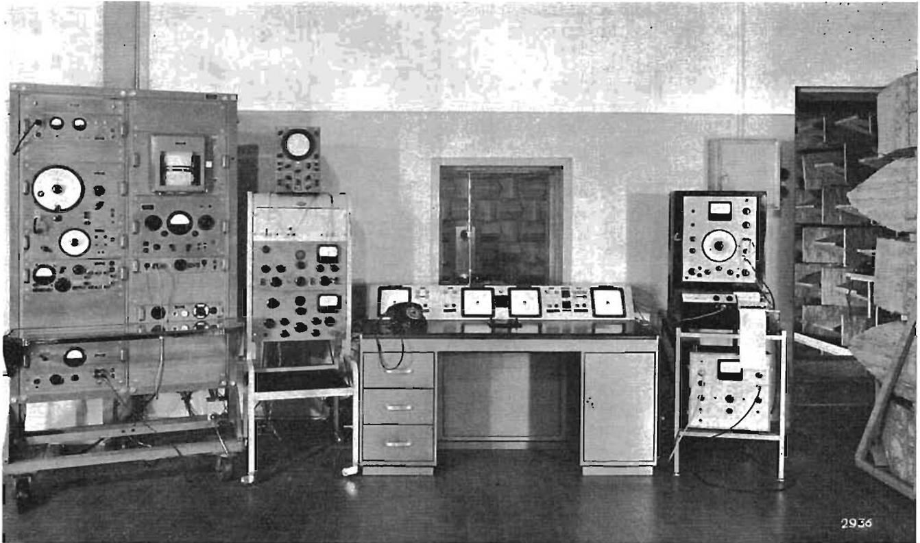
Fig. 6. — Strumentazione per le misure nella camera anecoica installate nella saletta adiacente.
