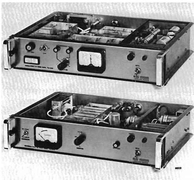
Fig. 29. — Modulatore (in alto) e demodulatore (in basso) video a 70 MHz a modulazione di frequenza che possono essere impiegati per brevi collegamenti su cavo coassiale (fino a 3 km su cavo coassiale nazionale) per esempio tra Centri di Produzione e relativi trasmettitori. Il modulatore può anche essere usato per l'inserzione di un segnale video in un punto qualsiasi della catena dei ponti fissi.
