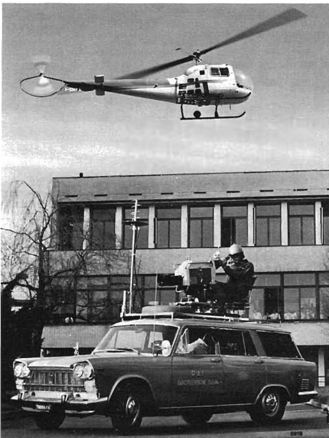
Fig. 25. — Ripresa TV in movimento con ripetitore su elicottero. Sono stati sostituiti i vecchi apparati a valvole con nuovi a transistori ed il collegamento video ed audio è stato completamente raddoppiato; i due canali sono combinati su di un'unica antenna visibile sotto l'elicottero.
