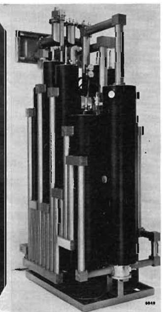
Fig. 56. — Unità combinatrice audio-video e vestigiale per trasmettitori TV da 5 kW per la banda I.
