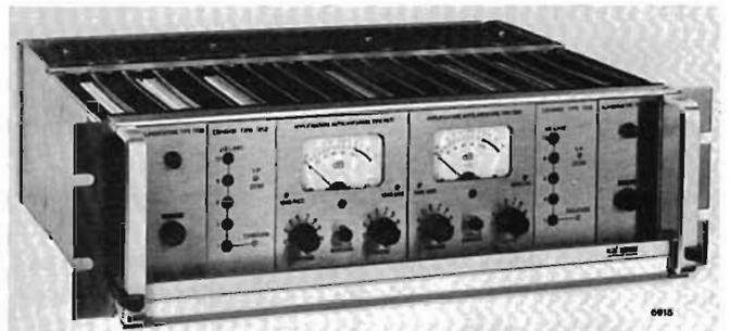
Fig. 22. — Limitatore stereofonico. Nel canale audio è impiegata una linea di ritardo di 300 microsecondi che consente di predisporre il guadagno dello stadio a guadagno variabile all'arrivo del sovravello che deve essere limitato, eliminando così qualsiasi distorsione anche in regime transitorio.
