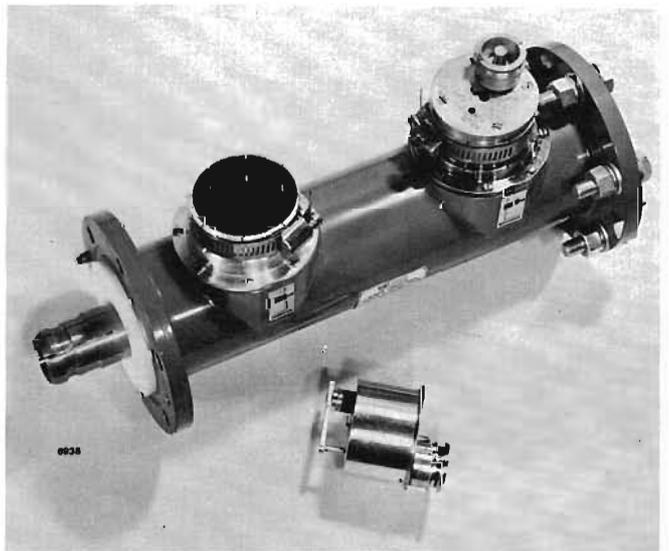
Fig. 42. — Accoppiatore direzionale per il prelievo della potenza diretta e riflessa a scopo di controllo, misure e sintonie di apparati. Potenza massima di transito: 25 kW fino a 600 MHz. A seconda della frequenza e/o della regolazione si può ottenere una direttività di 40 ÷ 45 dB con un accoppiamento della potenza diretta tra -20 e -50 dB.
