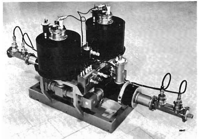
Fig. 54. — Unità combinatrice audio-video per trasmettitori TV da 10 kW, banda IV. È attrezzato con due cavità cilindriche ( $TM_{010}$ ) su cui è applicato un dispositivo idraulico di compensazione automatica della deriva della sintonia dovuta alle variazioni termiche (bibl. 64, 65).
