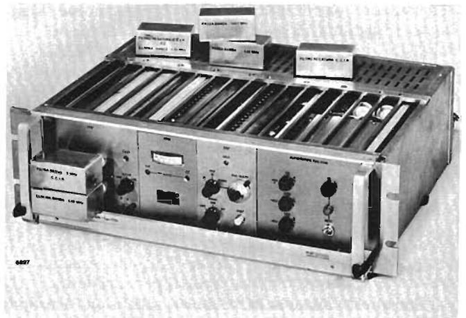
Fig. 4. — Misuratore automatico del rapporto segnale/rumore: è uno strumento che può eseguire questa misura anche durante le normali trasmissioni utilizzando le righe 22 e 335 della cancellazione di quadro. Corredato di filtri passabanda può misurare anche i prodotti di intermodulazione che cadono nella banda  $0,2 \pm 5$  MHz. La sua dinamica si estende fino a 80 dB (bibl. 12, 33).
