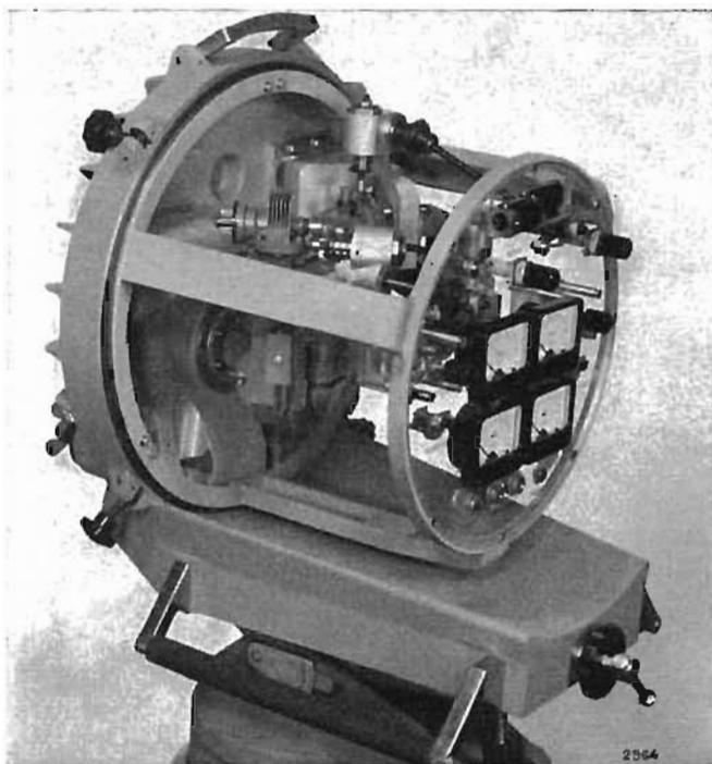
Fig. 28. — Testata del nuovo ponte radio doppio a microonde (7000 MHz). Questo ponte radio consentirà un duplice collegamento, ognuno con segnale video ed audio fornendo così una riserva attiva. Sarà completamente transistorizzato, eccettuato i Klystron.
