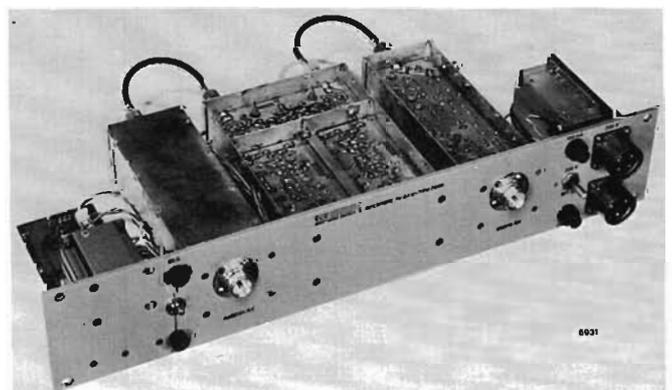
Fig. 38. — Ripetitore TV da 0,1 W in banda I e III con potenza di alimentazione di soli circa 1,5 watt a doppia conversione con amplificazione a frequenza intermedia.
