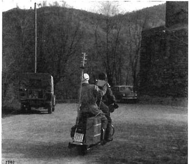
Fig. 24. — Moto Harley-Davidson equipaggiata con telecamera a vidicon e trasmettitore per collegamento con l'elicottero. La moto è più adatta dell'auto nel caso di necessità di piccolo ingombro come talvolta accade per le corse ciclistiche, ed in cui può essere valida anche la telecamera a vidicon. L'alimentazione è fornita al complesso da una batteria con elevatori di tensione a transistori.
