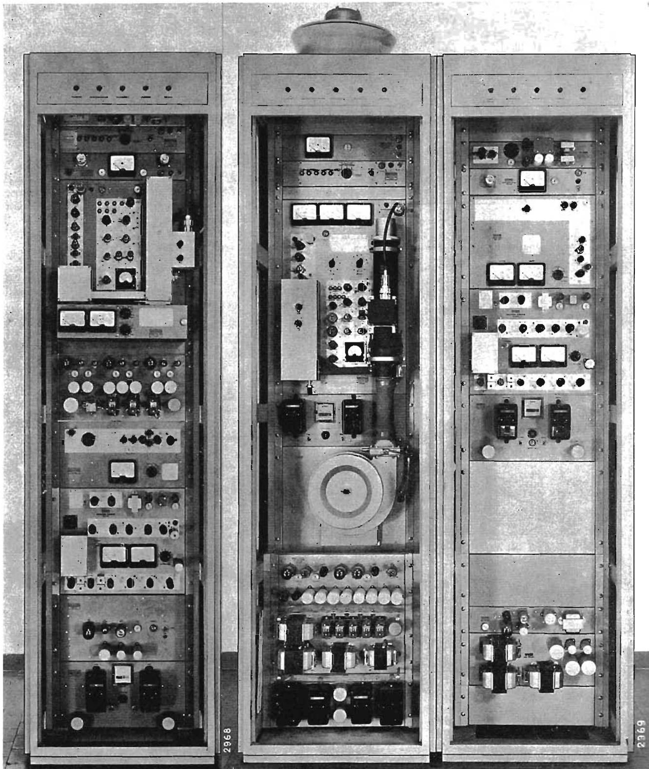
Fig. 31. — Complesso trasmettente TV VHF. Nella parte superiore è sistemato il trasmettitore video da 20 W; nella parte inferiore è sistemato il trasmettitore audio da 5 W. I trasmettitori sono completi di alimentatori ed automatismi.
