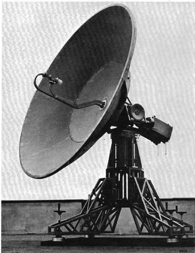
Fig. 32. — Antenna parabolica per collegamenti televisivi mobili nella banda dei 7 GHz a doppia polarizzazione lineare incrociata. Sul retro sono poste le due teste trasmettenti (o riceventi). Il paraboloide, in vetroresina metallizzata, ha un diametro di 3 m ed è scomponibile in sei spicchi per facilitarne il trasporto. Il combinatore di polarizzazione è posto sull'illuminatore. Il guadagno è di 43 dB.
