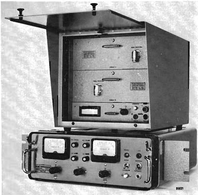
Fig. 28. — Ricevitore a MF video ed audio in banda V con cifra di rumore di 8 dB. Per evitare l'attenuazione dovuta ad un lungo cavo tra antenna e ricevitore la parte a radiofrequenza ed a frequenza intermedia (sopra) è separata dalla parte di demodolazione (sotto) che può essere posta fino a 200 metri di distanza.
