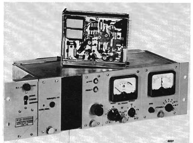
Fig. 34. — Modulatore MF stereo impiegato nel trasmettitore della figura precedente; esso impiega un originale sistema di controllo della frequenza e dispone di due entrate indipendenti per segnali monofonici o stereofonici.
