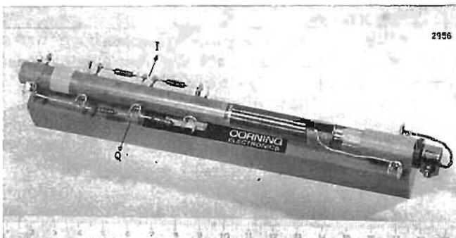
Fig. 20. — Linea di ritardo ad ultrasuoni per ricezione a colori con il sistema PAL. La linea è corredata dai circuiti compensativi e di somma e fornisce direttamente le due informazioni cromatiche I e Q senza l'impiego di elementi attivi.
