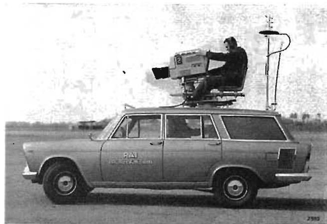
Fig. 23. — Auto FIAT 2300 attrezzata con telecamera ad image orthicon da 3" e trasmettitore per il collegamento con l'elicottero. All'interno è visibile il tecnico al controllo camera. Il complesso è alimentato da un gruppo elettrogeno sistemato nella parte posteriore dell'auto. Attualmente è in fase di costruzione la versione a transistori alimentata a batterie. Sono visibili l'antenna ad elica per il collegamento video e l'antenna a stilo per il collegamento telefonico.
