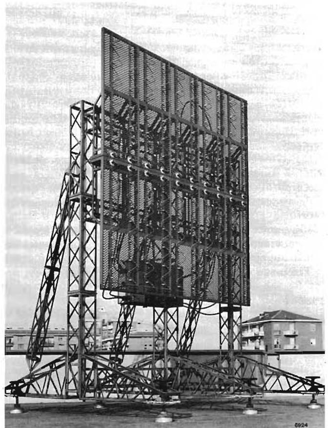
Fig. 31. — Antenna direttiva in banda V per collegamenti televisivi mobili. Il sistema radiante è costituito da dieci elementi doppi a zig-zag per una superficie di 9,5 m<sup>2</sup>. Il lobo di radiazione è orientabile elettricamente con sfasatori continui sia nel piano orizzontale sia nel piano verticale. Il guadagno è di 28 dB. Il sistema è scomponibile in piccole parti per facilitarne il trasporto.
