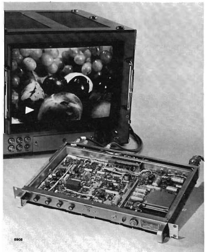
Fig. 15. — Generatore di segnale di inizio programma. Genera un triangolo bianco pulsante che si sovrappone al segnale irradiato da una rete TV quando nell'altra sta per iniziare un nuovo programma.
