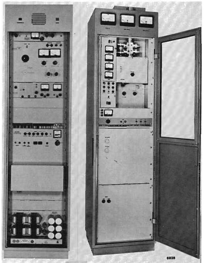
Fig. 33. — Trasmettitore radiofonico a modulazione di frequenza da 3 kW, adatto anche per trasmissioni stereofoniche. La cabina di sinistra è un trasmettitore da 200 W, che può anche funzionare in maniera autonoma; la cabina di destra contiene l'amplificatore da 3 kW di potenza (bibl. 61).
