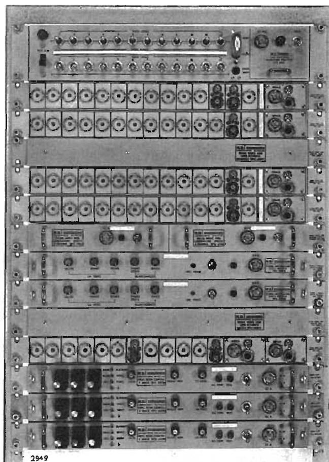
Fig. 15a. — Consolle di comando del «mixer» video. La consolle è munita anche di monitor e oscillografo, nonché di comandi per la partenza delle macchine di registrazione video. Fig. 15b. — Parte elettronica del «mixer» video. È fornita di 12 gruppi: 5 di commutazione, 2 di sfumo, 3 di somma dei sincronismi, 1 doppio per gli «effetti» ed 1 per organi ausiliari. Ogni gruppo di commutazione contiene 12 commutatori doppi elettronici ognuno estraibile ad innesto.
