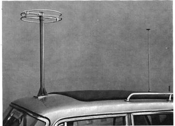
Fig. 53. — Auto attrezzata per radiocronisti, con due antenne per collegamento a modulazione di frequenza. A sinistra antenna a polarizzazione orizzontale, a destra a polarizzazione verticale.
