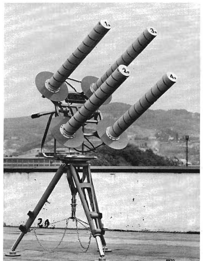
Fig. 27. — Antenna ad eliche direttiva per TV in banda V a polarizzazione verticale. È utilizzata per ricevere i due canali televisivi provenienti da elicottero per collegamenti mobili. Guadagno: 18 dB. È a puntamento manuale con controllo ottico con cannocchiale oppure elettrico con strumento con indicatore di campo.
