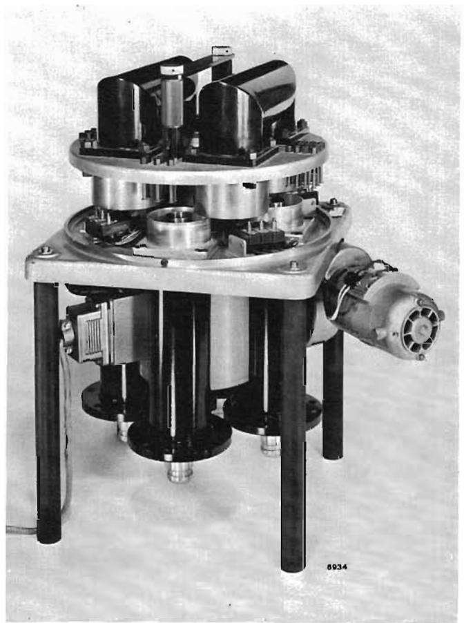
Fig. 41. — Commutatore a doppio scambio comandato a motore per "feeder" da 3 1/8". È utilizzato per collegare automaticamente l'antenna al trasmettitore di riserva in caso di avaria. È provvisto di numerosi contatti ausiliari di sicurezza e per il comando degli apparati. Consente il transito di una potenza massima di 25 kW fino a 600 MHz.
