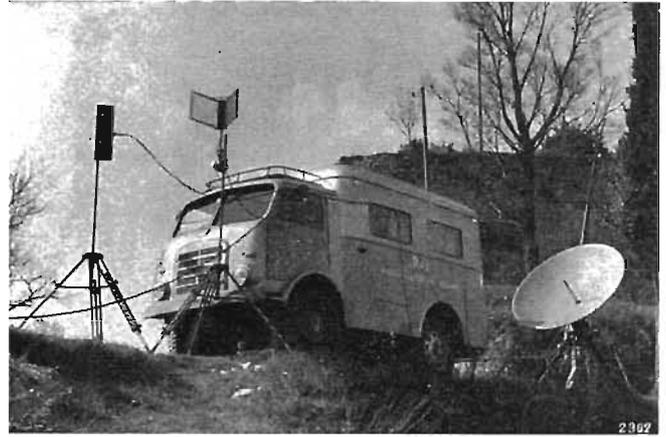
Fig. 26. — Automezzo attrezzato per la ricezione video dall'elicottero. Tre diversi sistemi di antenne connessi a tre ricevitori tutti sulla stessa frequenza permettono di scegliere il migliore segnale nelle varie condizioni. La selezione può anche essere automatica.
