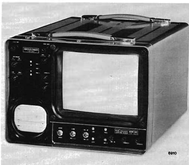
Fig. 17. — Monitor con cinescopio da 10 pollici munito di videoscillografo per il controllo dell'immagine e dei livelli del segnale video. Questo monitor è alimentato in corrente continua a 24 V ed è particolarmente adatto ad essere usato su mezzi mobili di ripresa.
