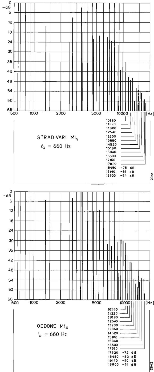
Fig. 10a - 10b — Analisi armonica della nota MI<sub>4</sub> (660 Hz) effettuata su due violini: uno Stradivari e l'altro Oddone. Si può notare il diverso contenuto armonico e la diversa legge di distribuzione tra le armoniche.
