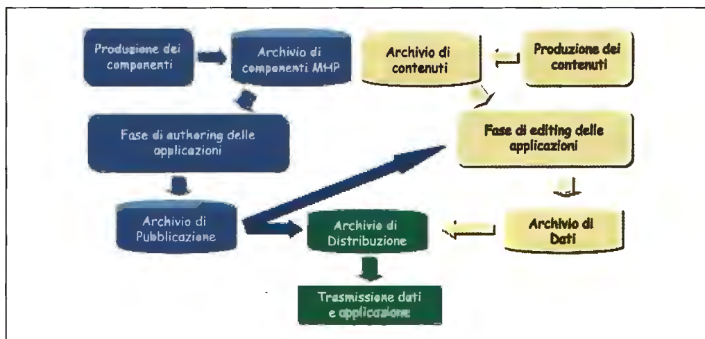
Fig. 7 - Architettura dell'ipotesica catena di produzione e distribuzione dei servizi MHP offerti dalla RAI. Sono visibili le fasi di authoring (color azzurro) ed editing - caratterizzazione (color giallo) delle applicazioni. Dall'archivio di pubblicazione, le applicazioni possono essere direttamente distribuite, oppure sottoposte a una o più operazioni di editing.
